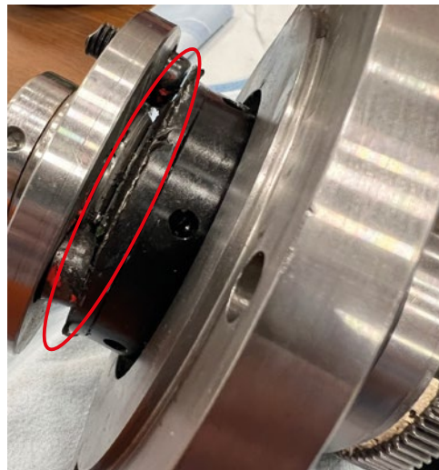
Abbildung 2: Verstellereinheit für Seiten- und Umfangsregister mit mächtig aufgeworfenem Stahl-Material (rote Markierung).
